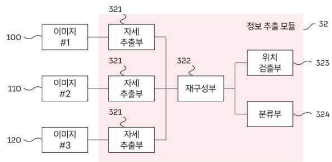
접촉자 추적 시스템의 정보추출모듈의 구성을 나타내는 블록도
