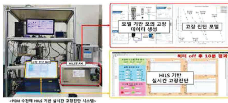
&lt;PEM 수전해 HILS 기반 실시간 고장진단 시스템&gt;
