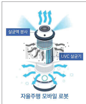
〈 자율주행 방역 로봇 개념도 및 개발 시스템 〉
