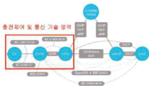
[ 전기자동차 충전 인프라 통신 시스템 표준 구성도 ]
